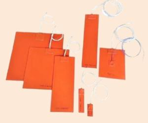
シリコンラバーヒーター：金属と同形状のシリコンラバーヒーターを製作し、両面テープで金属に貼り付け使用。ピンポイントで金属のみ温めることが可能となります。
