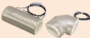
マントルヒーター：特に油が堆積しやすいエルボにヒーターを取り付けました。人の通る所に配管があり、誤ってヒーターに触れてしまうとやけどの危険性があるため、ヒーターは断熱材一体型にして、触っても問題ないようにしました。配管の清掃があるため、ワンタッチで取り外しが可能な加工を施しました。
