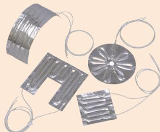
アルミ箔ヒーター：攪拌機の外側にアルミ箔ヒーターを張り付けた後、上から断熱材で覆いました。断熱材をつけることで熱効率が向上し、熱の均一性が図れました。
