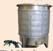
マントルヒーター：ホッパータンクの円すい部分にヒーターを巻き付けて加熱を行いました。異物混入を防ぐため、ガラス繊維が飛散しないPTFE(フッ素樹脂)クロスを使用し、タンク洗浄の際にヒーターが簡単に外せる加工を施しました。
