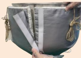
マントルヒーター：タンクの外側と底面をヒーターで覆い、タンクへの熱伝導をよくするために金具でヒーターを持ち上げ、タンクへ密着するように取り付けました。
