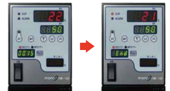
※ONタイマーを設定し、時間経過したためOUTランプが点灯(ヒーターへの通電開始)
