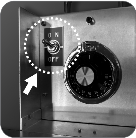
3. コントロールボックスを引き出し 電源スイッチをONにします。 (パイロットランプが点灯します)
