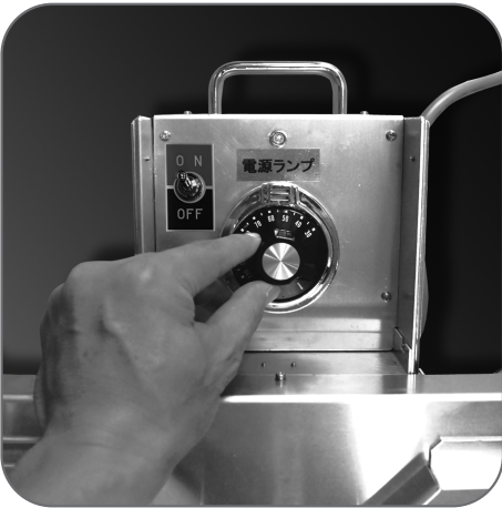
4. ダイヤルを回して温度を調節します。 (110℃まで)
