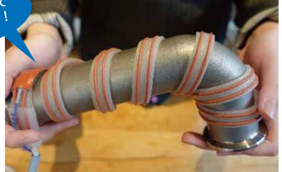
ヒーター巻きつけ時間、約1分 ※ヒーター長1mの場合
