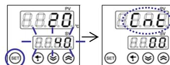
SET を押して、モニターセンサー (in2) に変更します。
