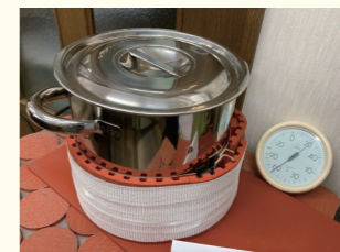
鍋の周りに巻き付けたヒーターの上からシリコンスポンジを巻いた場合（弊社による実験）
